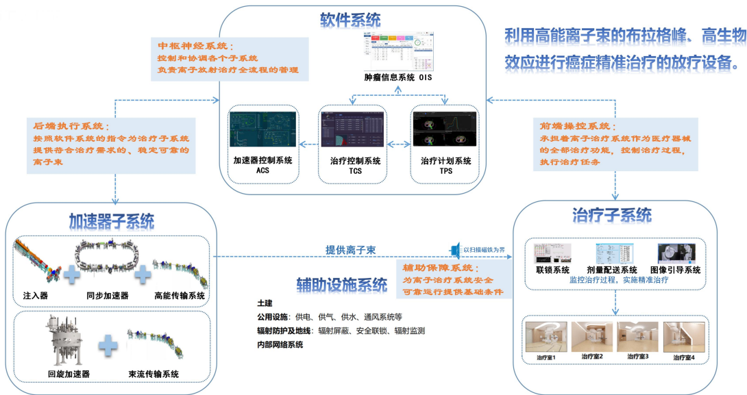
图 7 碳离子/质子治疗系统结构组成示意图
